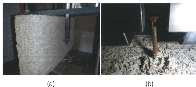
Figure 2 – Configuration d'essai - résistance transversale (a) et axiale (b) des fixations dans un bloc de chanvre ISOHEMP
