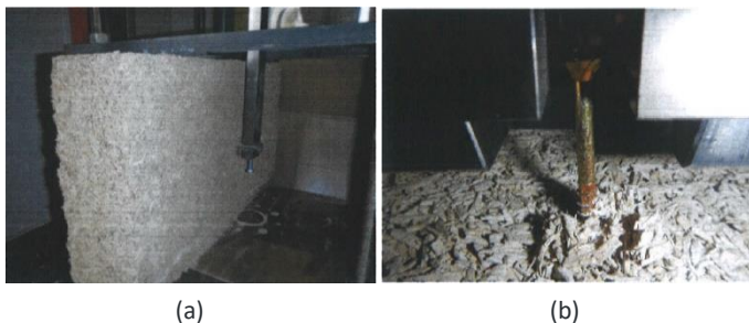
Fig. 2 – Proefopstelling – transversale (a) en axiale (b) treksterkte van bevestigingen in ISOHEMP hennepblok
