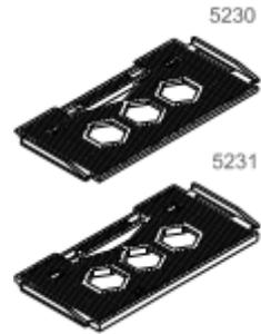
**Figure 6c: Connecteur d'angle soudable des portes**
