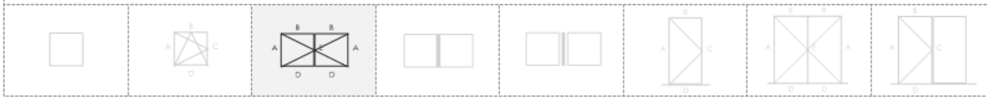
Figuur 7c: Typesnede dubbel opendraaiend venster met en zonder makelaar
