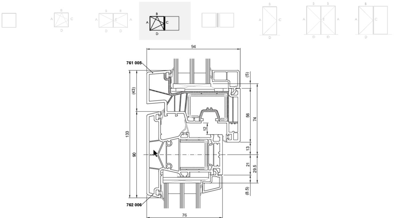
Figure 8 : Drainage et égalisation de la pression
