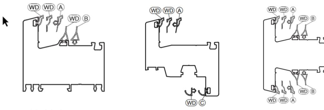
WD : Coextrusion des joints de type « joint de vitrage et de frappe 464000 dormant », de type « joint de frappe 464001 ouvrant » et de type « 464102 joint central pour le dormant et les profilés en T ».
