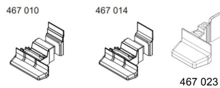
Figure 6b : Blocs de réglage et cales à vitrage
