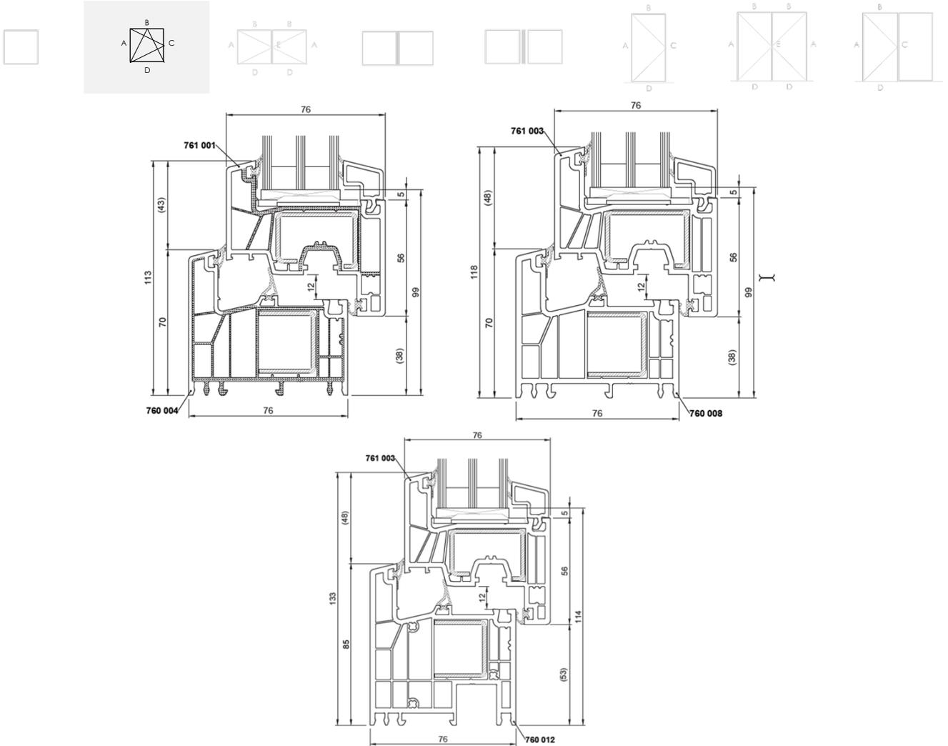
Figure 7c : Coupe-type de fenêtre à double ouvrant avec maucclair
