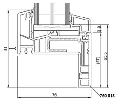
Figure 7b : Coupe-type de fenêtre oscillo-battante
