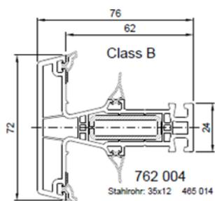
Figure 2d : Assemblage mécanique en T
