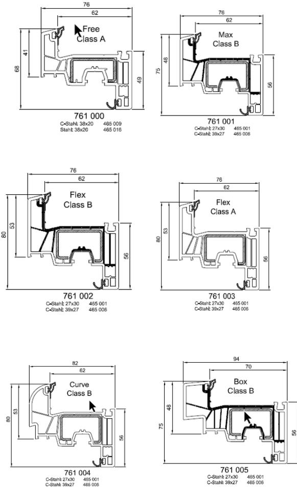
Figure 2c : Montants intermédiaires et traverses - Mono-extrusion
