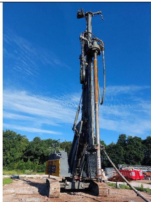
Fig. 2 : Exemple de machine à pieux
