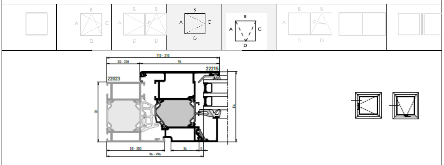
Figuur 9: Typesnede naar buiten opengaand
