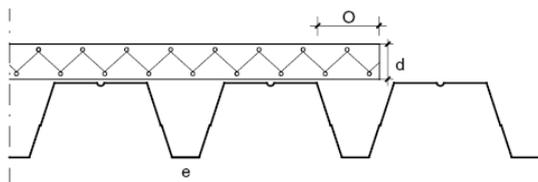
L'ouverture d'onde maximale autorisée (e) dépend de l'épaisseur de l'isolation :  $e \leq 3 \times d$ , avec :
