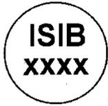
En apposant le label ISIB, un label transparent mentionnant le numéro de certification du placeur du modèle ci-dessous (diamètre : 22 mm), appliqué au-dessus du label BENOR/ATG et en délivrant une attestation de placement, le placeur certifié assure que la pose du bloc-porte a été effectuée conformément au § 5 de cet agrément et qu'il en assume également la responsabilité.
