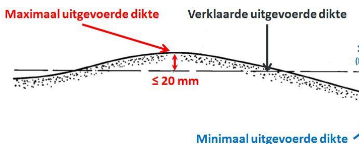
Fig. 1 – Bepaling van de verklaarde uitgevoerde dikte
