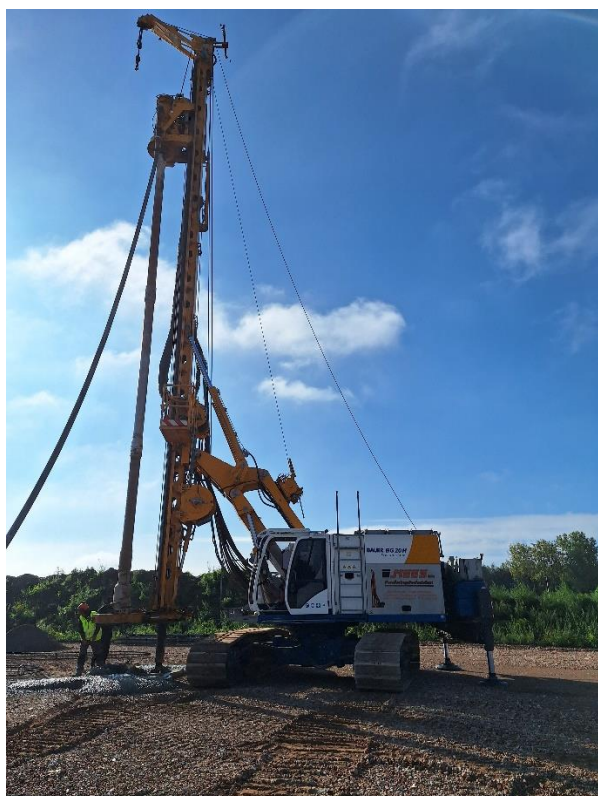
Fig. 2 : Voorbeeld van een paalendrijver
