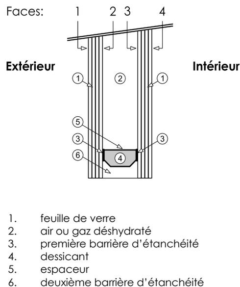
Fig. 1 Faces d'un vitrage isolant
