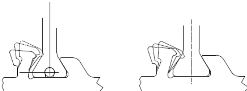
Fig. 2 – Exemple de pose de barrettes
