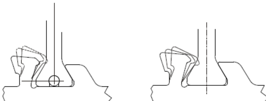
Fig. 2 Voorbeeld plaatsing strippen
