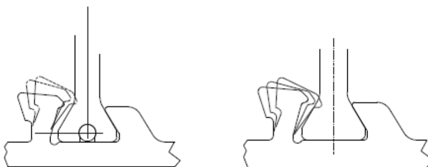
Figuur 2 – Voorbeeld plaatsing strippen
