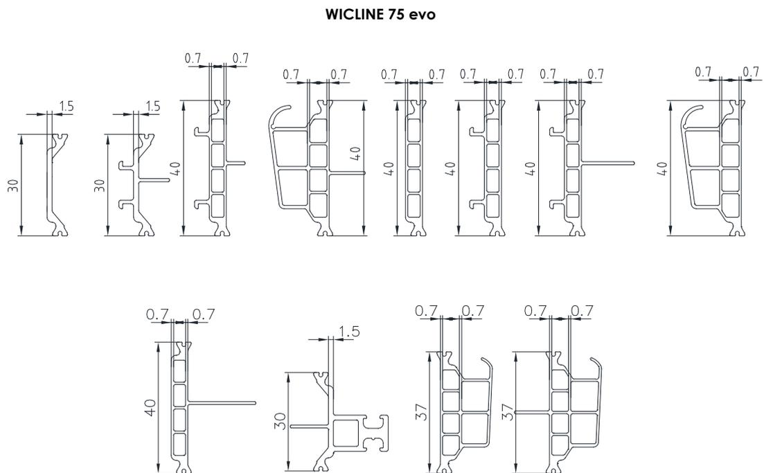
Figure 3 – Exemple de coupures thermiques en PPE/PA
